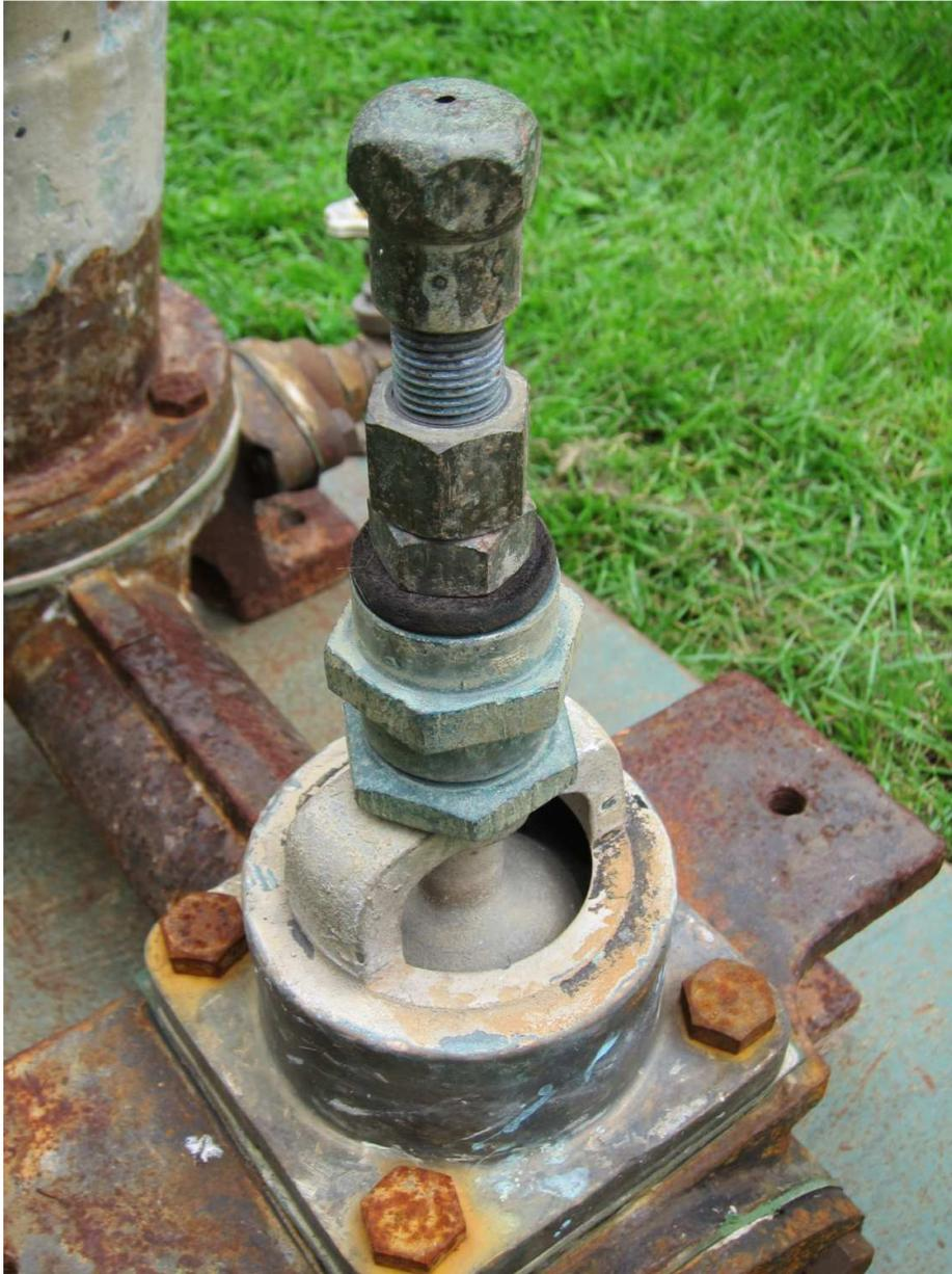
Das obige Bild zeigt das für die Holter Widderanlage verwendete Stoßventil, es ist robust gefertigt, hat einen einstellbaren Hub und ist gewichtsbelastet
