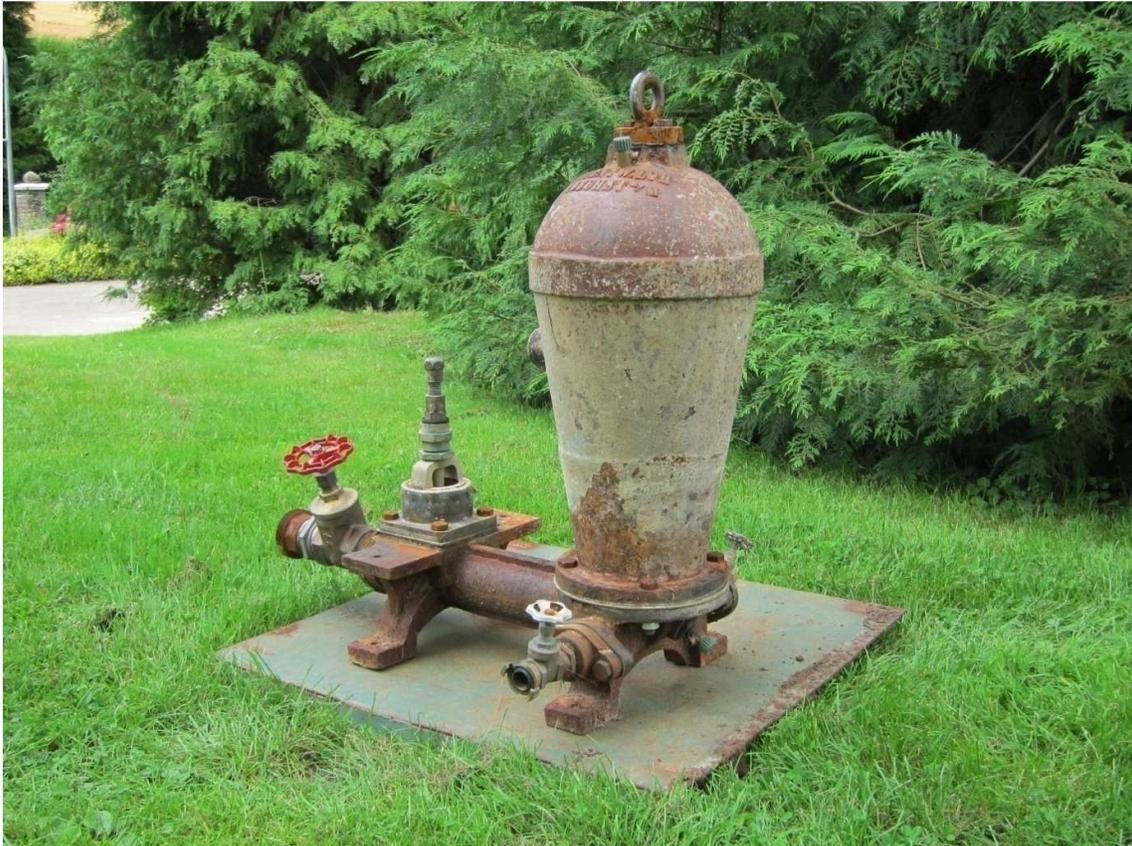
Selbst die Zollgewinde (Withworth-Gewinde) der Schrauben und Muttern an dem Widder weisen auf ein hohes Alter hin. Erst 1917 wurden die Deutschen Industrie Normen gegründet, danach erfolgte die Einführung des heutigen metrischen Gewindes.
