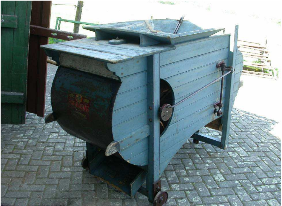
Foto: Windwehe. Platt: Wannemüelen (im Wort steckt noch die „Wanne“, die mit diesem Gerät überflüssig geworden war und die Mühle, aber nur, weil hier gedreht werden musste) Hersteller: Amazonenwerk
