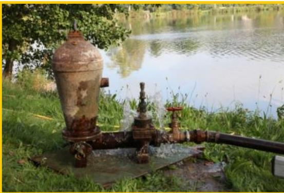
Das Bild zeigt den hydraulischen Widder während der Vorführung.
